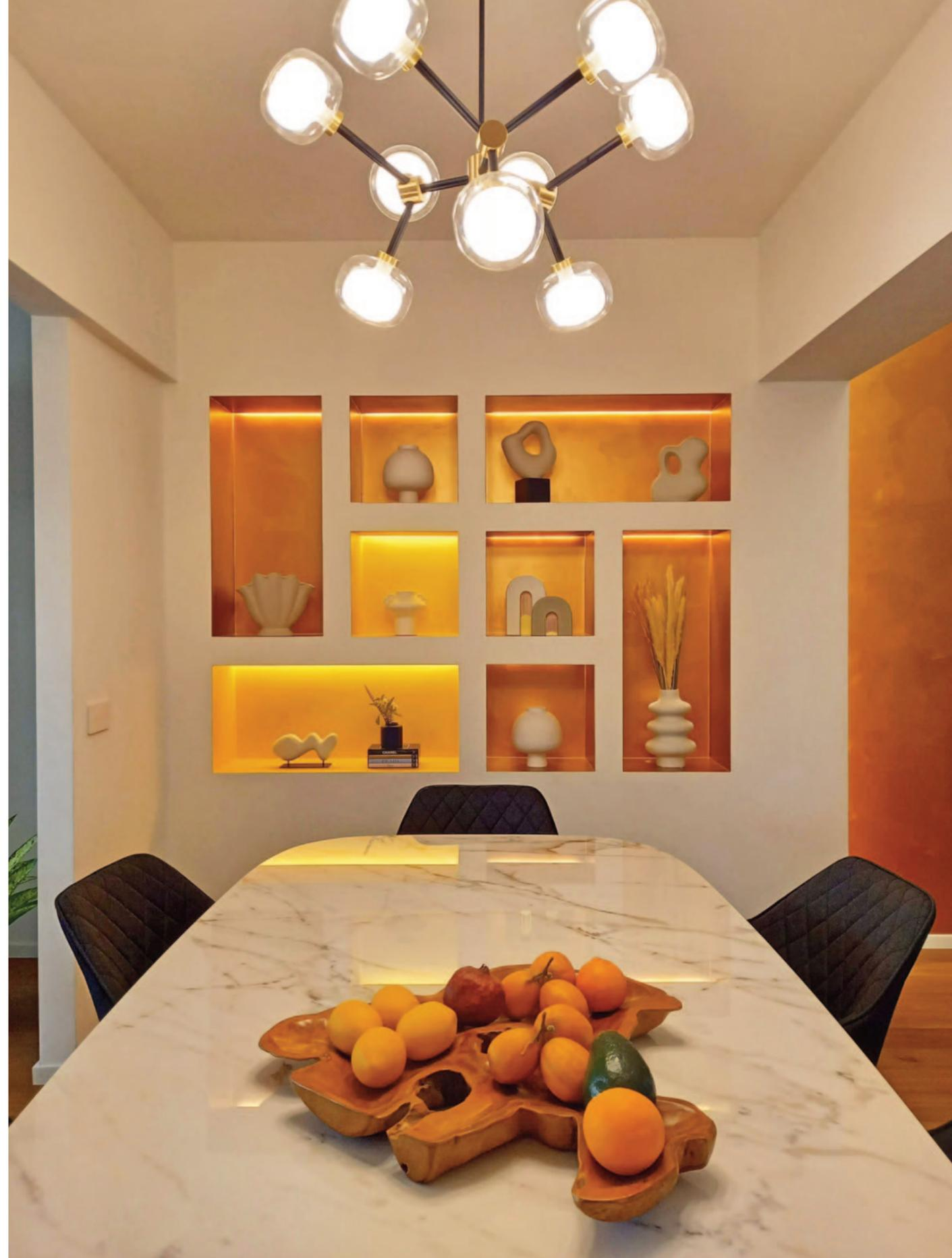
Sul fondo della zona pranzo, invece, i due pilastri generavano una rientranza, ora chiusa da una struttura in cartongesso che nella parte centrale offre un gioco di nicchie disposte con uno schema speculare e contrapposto, retroilluminate con profili di Macrolux e internamente rifinite con tonalità oro e rame coordinate con l'ambiente. La veletta che ricopre la trave tra zona pranzo e divani si estende in verticale sul pilastro fino a terra insieme alla retroilluminazione.
